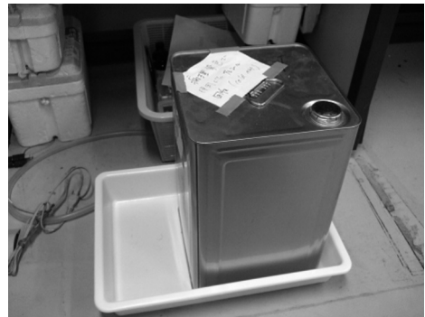
写真：廃液の貯留例(廃液用の一斗缶使用)
