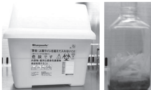
図：注射針は使用後リキャップせず左図のような専用の保管箱へ。また、先のとがったピペットチップなどは、滅菌操作中の事故を避けるために、右図のように、あらかじめ消毒薬をいれたプラスチックボトル内へ廃棄すると安全
