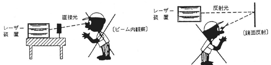
図5 レーザービーム内観察条件は3Bでは危険 1) (直接光、鏡面反射光共要注意)
