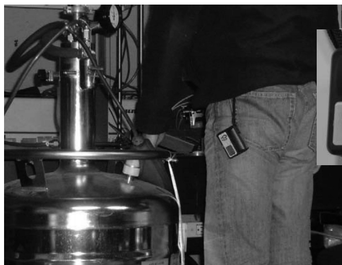
実験作業中に小型酸素濃度計を携帯する
