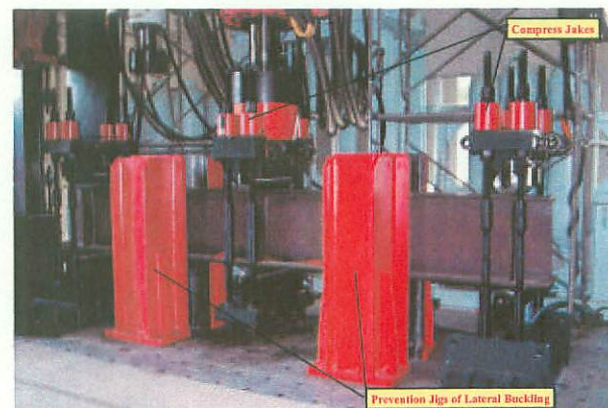
図-3 正負交番曲げ試験 橋桁やクレーンガーダーの疲労安全性照査を行います。
