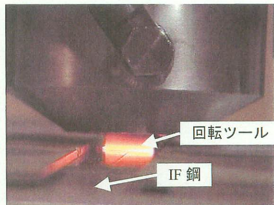
図-4 IF鋼の摩擦攪拌接合
