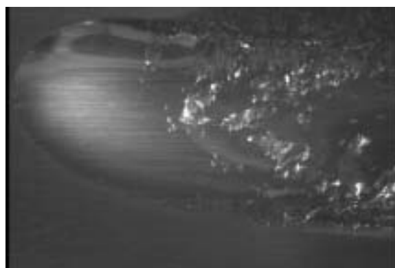
図1 横向き溶接の際の溶融池裏面の様子 接合中に超音波キャビテーションにより多数の気泡が放出されているのがわかる。
