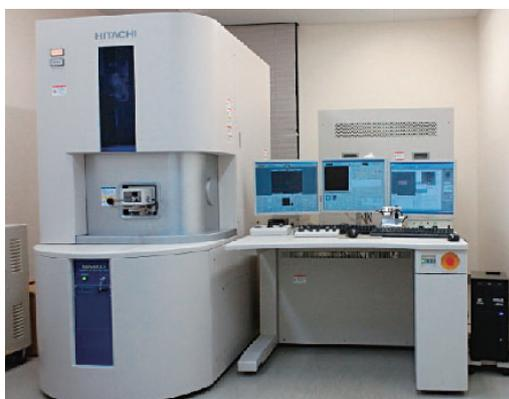
材料微細加工・微細組織観察・結晶方位解析
